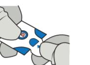
Fijar la cubierta a lo largo de la línea de corte. La fijación es necesaria para preservar los productos de la reacción en la célula expresa de la prueba.
